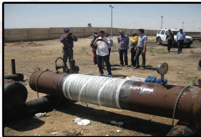
انجام تست هیدرو بر روی لوله ۲۶ اینچ در شرکت لوله و نفت و مخابرات منطقه شاهرود ( اردیبهشت ۹۶ )
